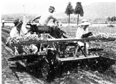
ついて, この度, サークル鉄工の研究グループ陣が開発したペーパーポット(紙筒)使用の高速度そ菜移植機を昨年夏以来検討した結果, 1日1ha以上の定植能力をもち, これまでのプランターの欠陥(精度, 収量ともに落ちる)を充分に解決し, キャベツ5t, レタス2.5tの収量があがり実用化に確信をもったことを記して終る。
